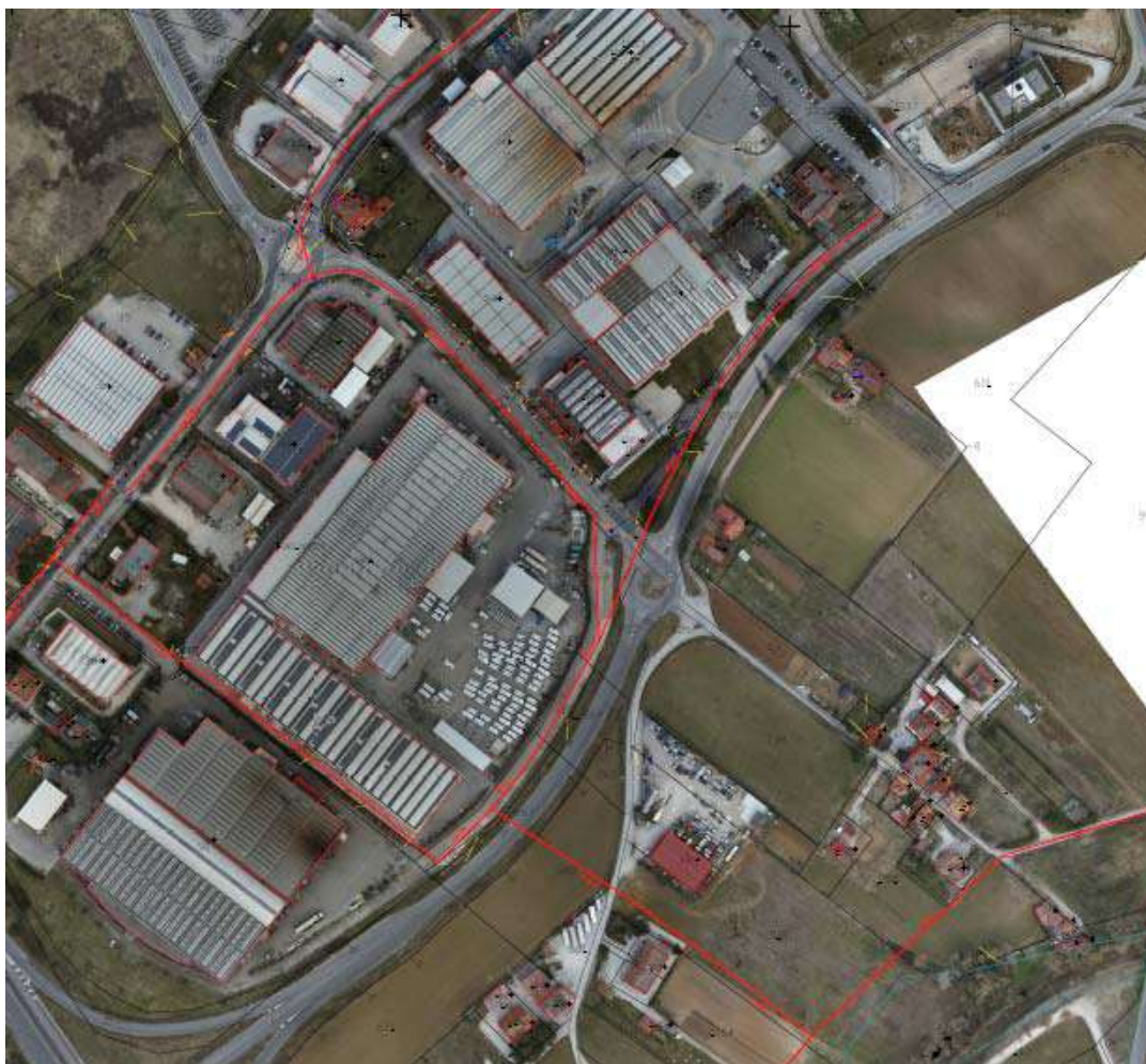
Figura 2 - Planimetria rete fognaria allo stato attuale
